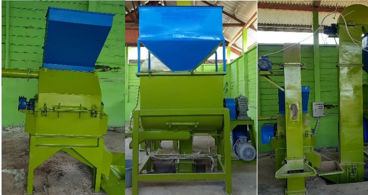
Gambar 3. Alat dan mesin produksi pada pabrik pakan mini yaitu Hammer mill (A), Mixer (B), dan conveyor (C).
