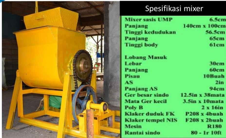
Gambar 2. Mesin pencampur (Mixer) kapasitas 50kg dan spesifikasinya
