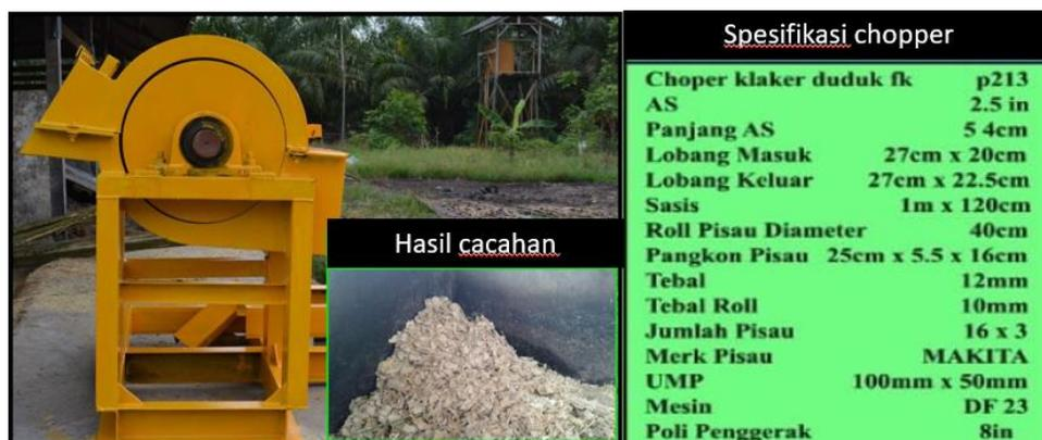
Gambar 3. Mesin chopper pelepah sawit dan spesifikasinya.
